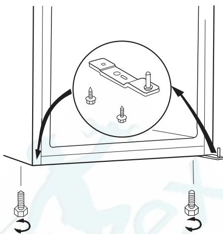
6. Отвинтите дальний винт внизу и установите на противоположной стороне.
